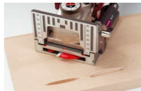
riparazione del legno (fresa per asportazione sacche di resina Art.No. 132217)
