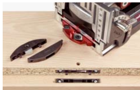
giunzioni con Clamex S (fresa da 8 mm Art.No. 132108 e dima di foratura Art.No. 125240)
