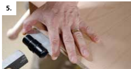
5. Introducir las espigas de fijación
