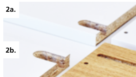
2a. Mecanizado de la pieza de trabajo, incluido el contorno, para el fresado del tapón 2b.
